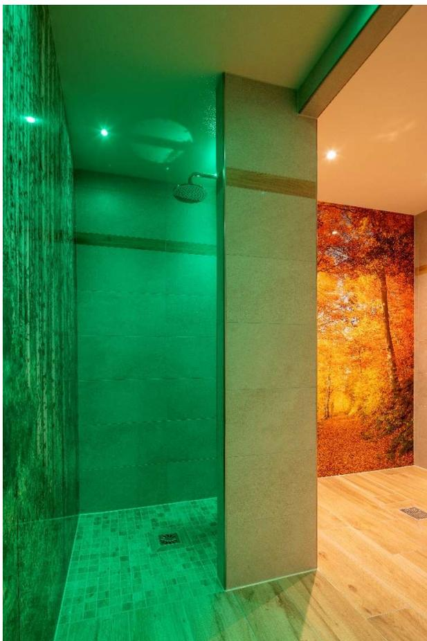
Deux receveurs de douche de plain pied de la gamme Fundo Primo ont été installés dans la nouvelle zone de douche. La pente intégrée en usine assure un écoulement optimal et empêche ainsi de manière fiable la formation de flaques d'eau.
